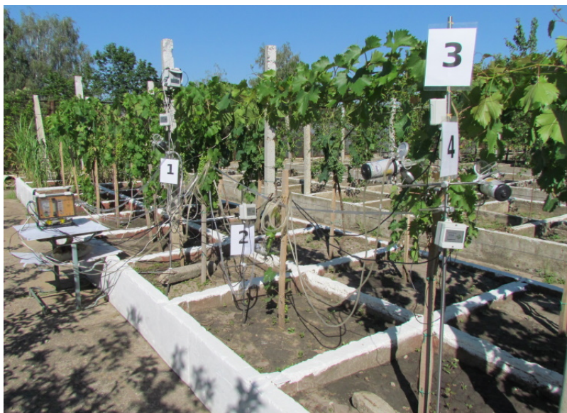
Рис. 1. Процесс мониторинга. Фитомонитор ПТМ-48 А.
